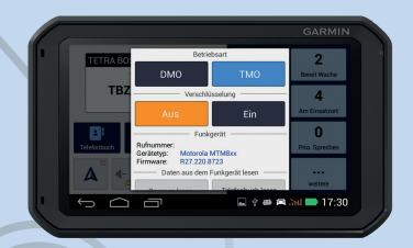
Einstellmenue für Betriebsart und BOS-Funktionen DMO/TMO Betriebsartumschaltung sowie die Umschaltung der Verschlüsselungsfunktion im Klartext.
